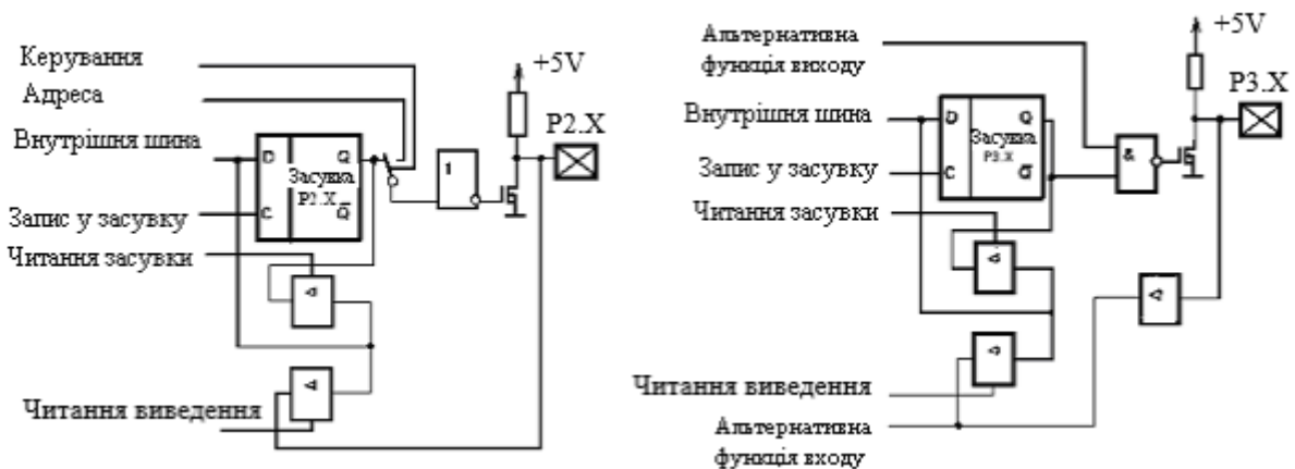
Рисунок Б.3 – Функціональні схеми каналів портів P2 і P3 +5
