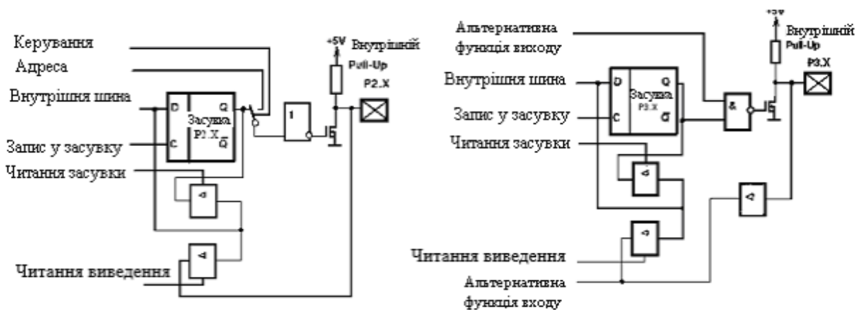
Рисунок 4.3 – Функціональні схеми каналів портів 2 і 3
